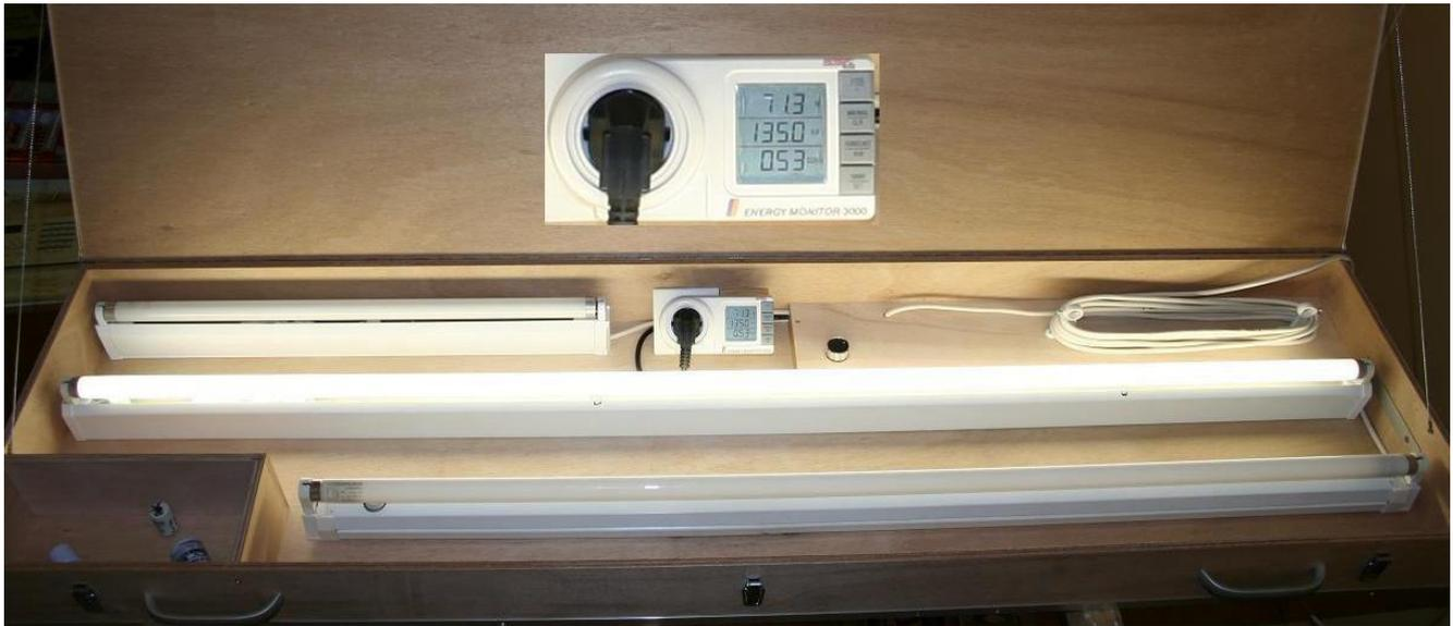
Ci-dessous, dans le même environnement, à éclairage identique, on constate que l' EPCR-35W consomme 38,2 watts avec une puissance réactive strictement identique. Ici un abonnement de 39W suffit ! Dans ce cas précis, l'économie d'énergie active « **facturée** » est de **46,42%**
